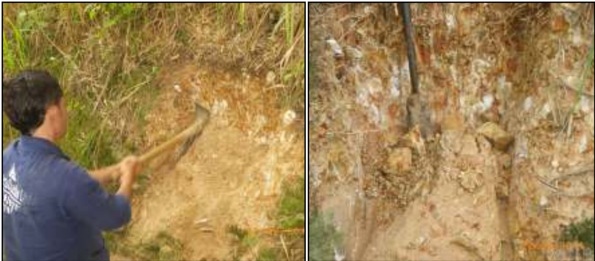
Ilustración 19. Ejecución Apique 4. Corona del talud
