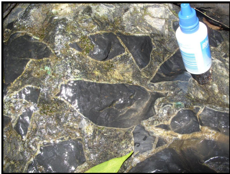
FIGURA 13. Aspecto de la variedad de brechas tipo I: monomítica con clastos de lodolita calcárea, angulares, en sectores con textura tipo jigsaw-fit, matriz de pirobitumen y cemento de carbonato, clorita y esfalerita.
