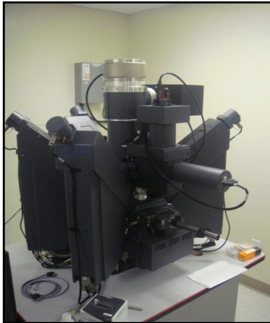
FIGURA 3. Imagen de los EDAX de la microsonda electrónica de marca CAMECA SX100, utilizada en el presente estudio.
