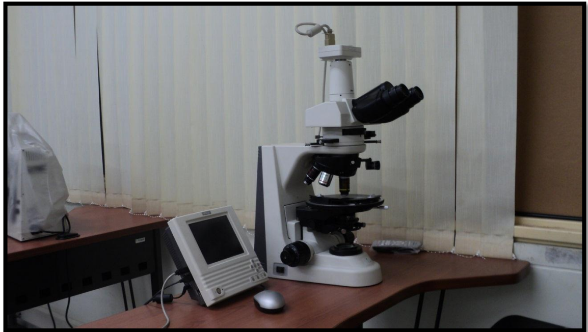
FIGURA 2. Microscopio de luz transmitida usado en la descripción petrográfica.
