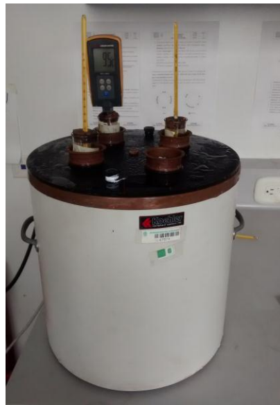
Figura 23. Equipo refrigeración para punto de fluidez
