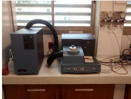
Figura 24. Equipo de Calorimetría de Barrido Diferencial (DSC)
