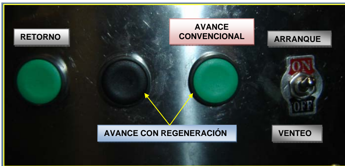
Figura 3.38. Tablero de control del sistema hidráulico modular.
