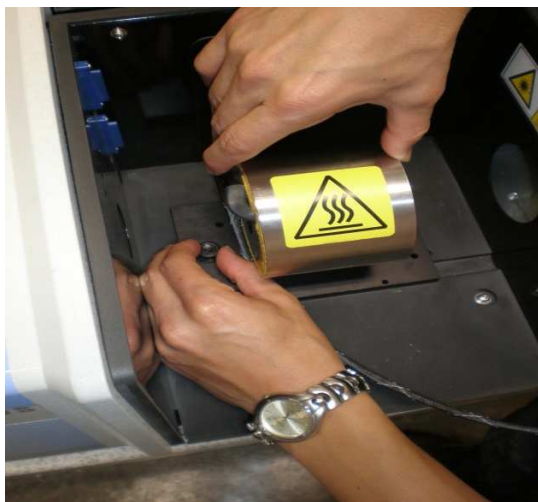
Figura 5. Montaje de la celda de calentamiento.
