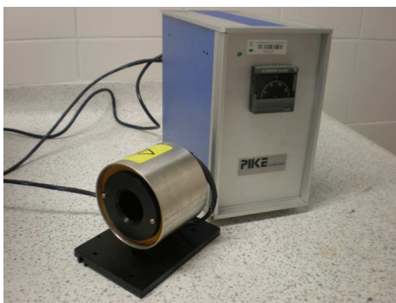
Figura 16. Celda de calentamiento conectada al controlador de temperatura.
