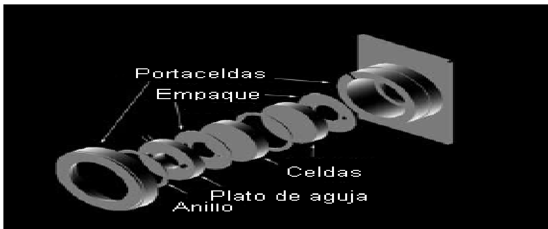
Figura 10. Montaje para muestras líquidas en análisis cuantitativo.
