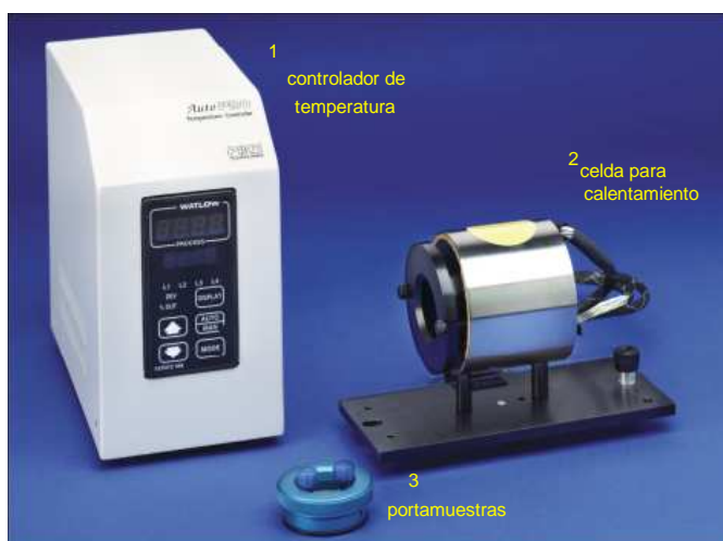
Figura 4. Celda de calentamiento con controlador de temperatura para líquidos.
