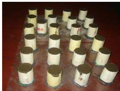
Figura 1. Probetas de cemento-arena-grava-agua con lodo saturado de Cu, Ni y Zn.
