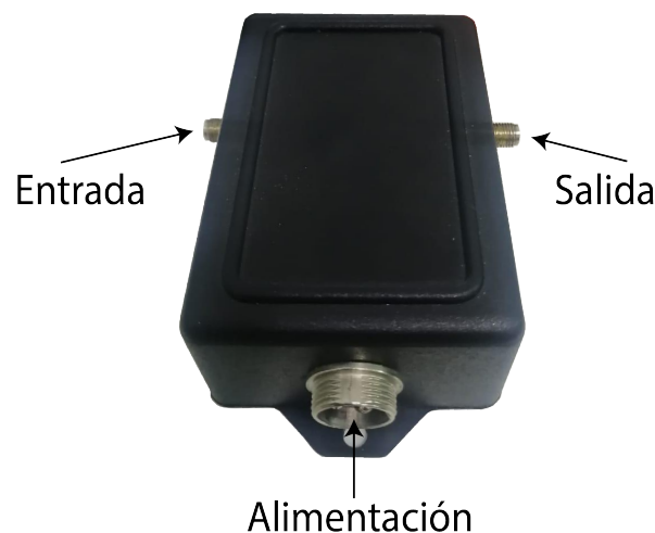
Figura 47. Circuito integrador ubicado en caja para intemperie. Cuenta con entradas y salidas tipo SMA y un cable para alimentación externa.
