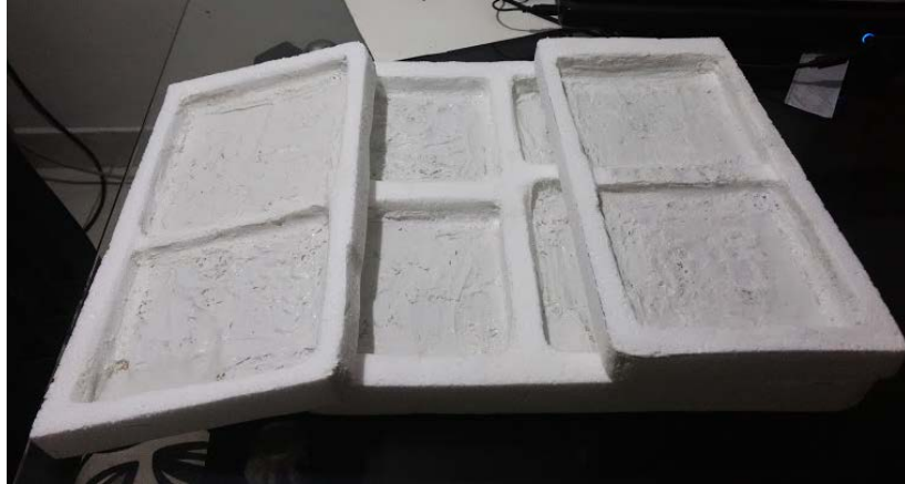
Gráfico 53. Enlucido de las superficies no uniformes con estuco plástico.
