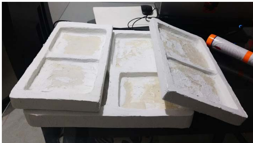
Gráfico 54. Módulos recubiertos con láminas de polipropileno y estuco plástico.
