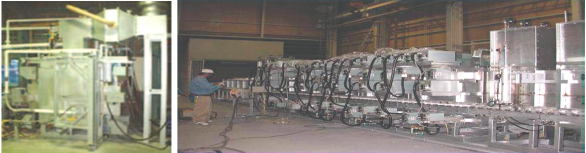
Figura 8. Horno Híbrido de Microondas y Gas (Izquierda) y Horno Puro Continuo de Microondas (Derecha) de Mino Yogyo Co. en Japón
