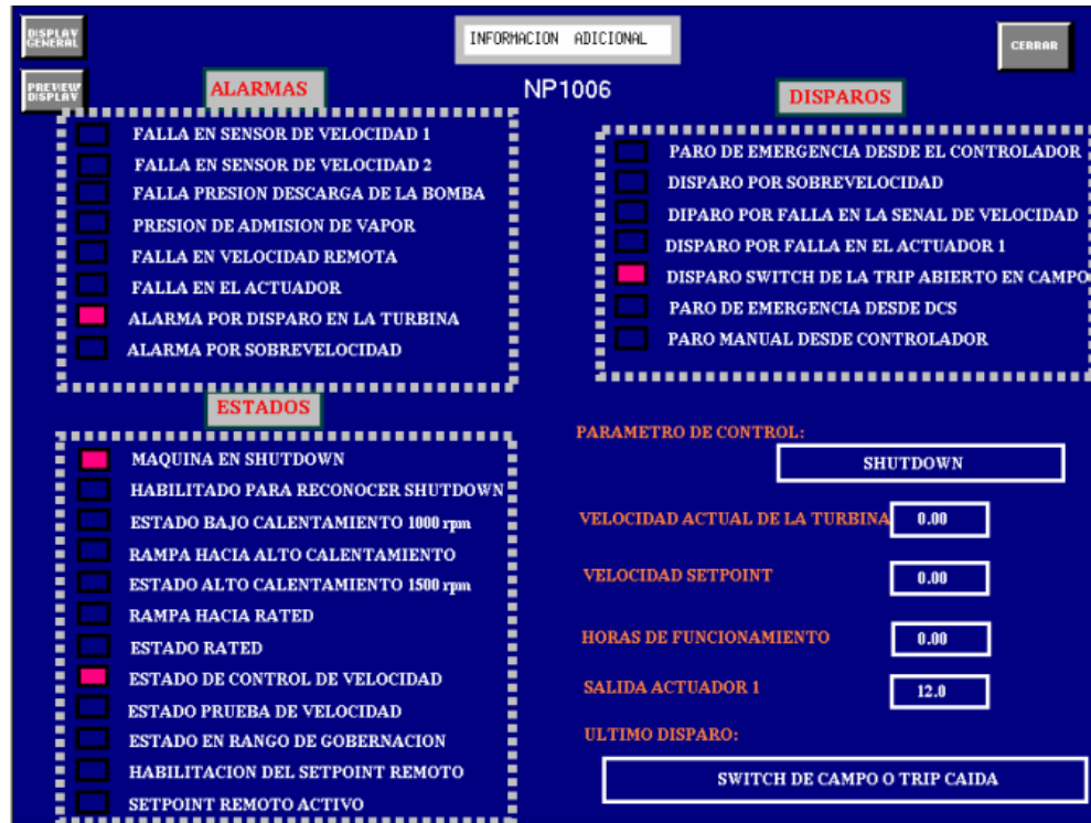
Figura 87. Información de la turbina NP1006 traída desde el gobernador
