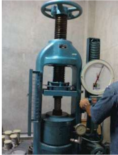
Figura 17. Prueba de Resistencia a la compresión. Maquina Universal de Ensayos INSOLTEC LTDA
