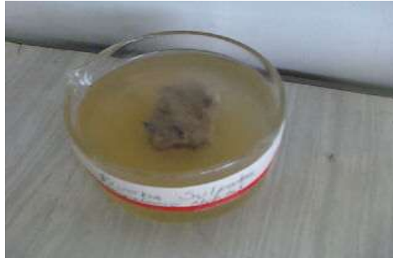
Figura 19. Imagen de las muestras de probetas sumergidas en ácido sulfúrico.
