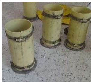
Figura 11. Tubos de PVC usados como moldes
