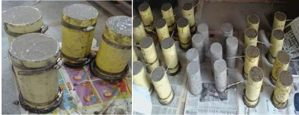
Figura 15. Probetas en proceso de secado y Desmoldado
