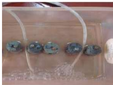
Figura 21. Probetas expuestas a ambiente corrosivo con flujo constante de oxígeno
