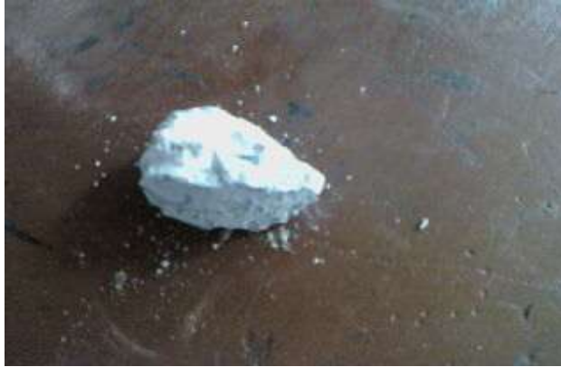
Figura 36. Muestras de probetas desgastadas por la solución saturada de sulfato de sodio
