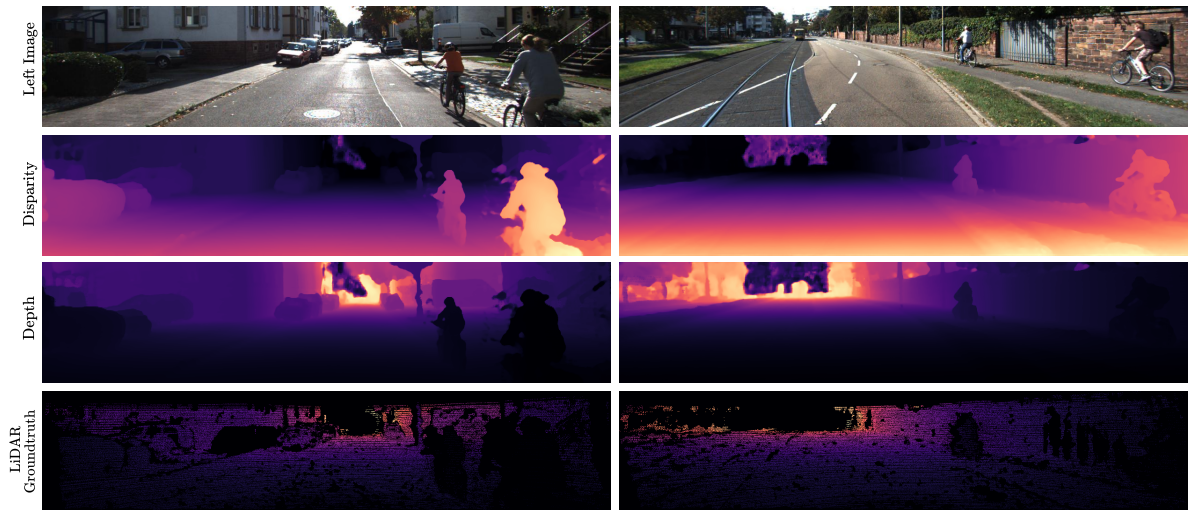
Figura 14. Resultados cualitativos del método propuesto. La primera fila presenta la imagen RGB de la izquierda; la segunda, la imagen de disparidad generada por el módulo de Stereo Matching ; la tercera, la estimación de profundidad resultante de nuestro algoritmo; y la cuarta, el ground-truth semi-denso.
