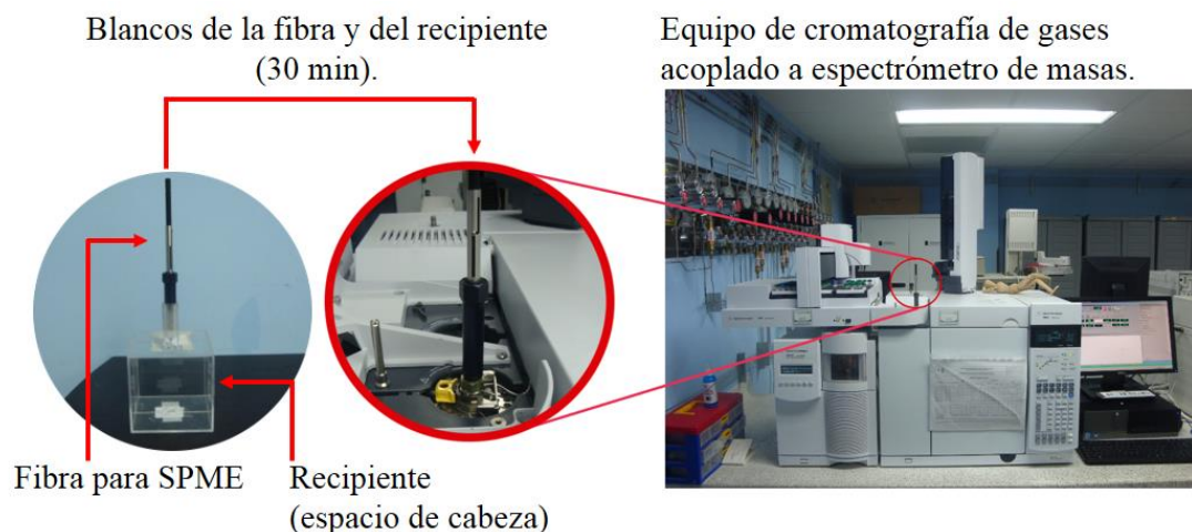
Figura 6. Blancos de la fibra (CAR/PDMS) y del recipiente de acrílico. Equipo para el análisis de los COV: Cromatógrafo de gases: Agilent Technologies GC 7890 (Palo alto, CA, EE.UU.), detector selectivo de masas: Agilent Technologies 5973C (Ionización por impacto de electrones, 70 eV). Laboratorio de Cromatografía y Espectrometría de Masas CROM-MASS, CENIVAM, UIS-Bucaramanga-Santander. Fotografías: Luis Romero, 2016.
