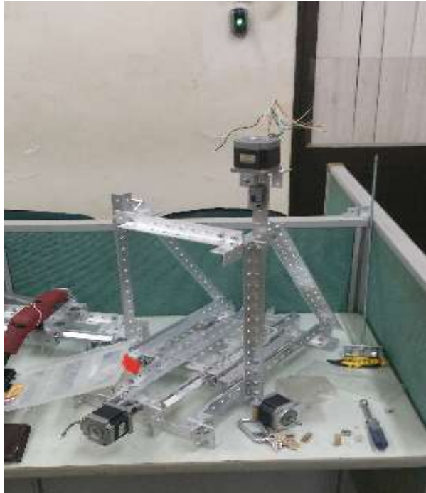
Figura 2. Máquina Mini CNC en proceso de ensamblaje.
