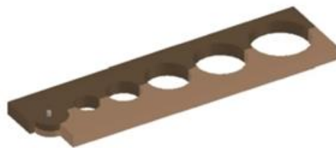
Figura 7. Prototipo para la estimación de diámetros de aceros de refuerzo
