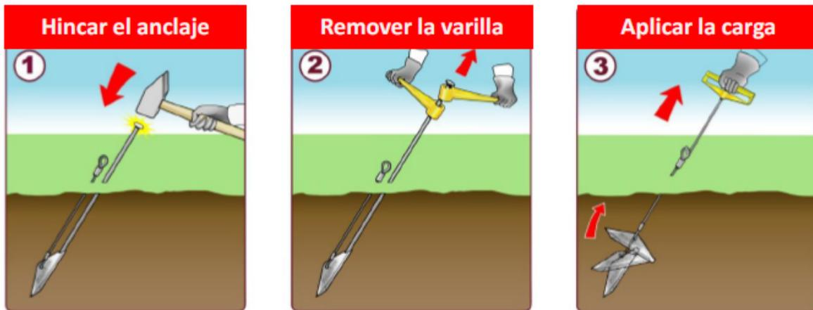
Sistema de anclaje de carácter pivotante instalado por percusión para suelos de grano fino.
