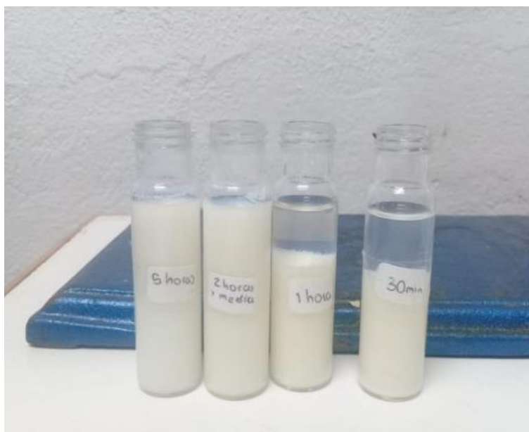
Figura 20. Materiales exfoliados después de unas horas de estar en reposo.
