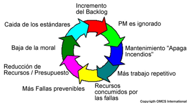
Figura 16. Ciclo vicioso de mantenimiento reactivo
