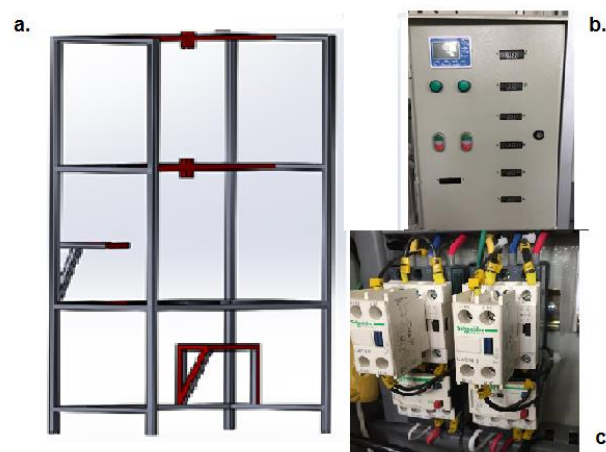
Figura 13. a. Estructura del piloto de evaporación b. Caja de equipos eléctricos y electrónicos del piloto c. Interior caja de equipos eléctricos y electrónicos, conexiones de bombas.
