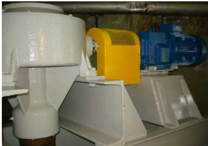
Foto 4. Foto del agitador de regeneración. Fuente: Dow Agrosciences
