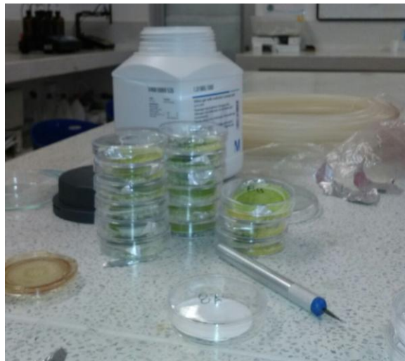
Figura 12. Fibras de vidrio con su respectivo filtro, silicagel y muestra.
