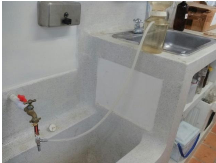
Figura 11. Procedimiento de pruebas de vacío, para su posterior cálculo de peso seco.
