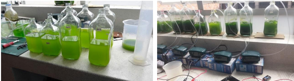
Figura 9. Reactores con mezcla entre microorganismos, agua destilada, corriente de aire.
