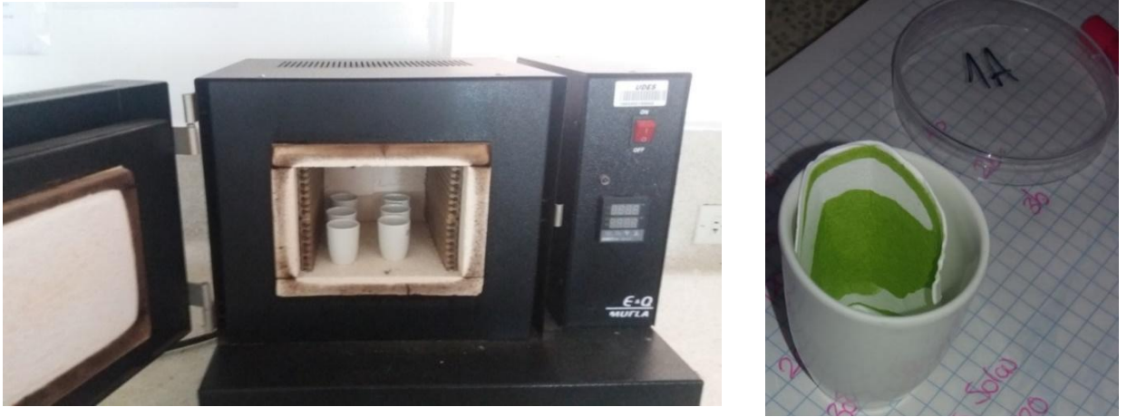
Figura 13. Filtros con muestra antes de ser introducidos en la mufla.
