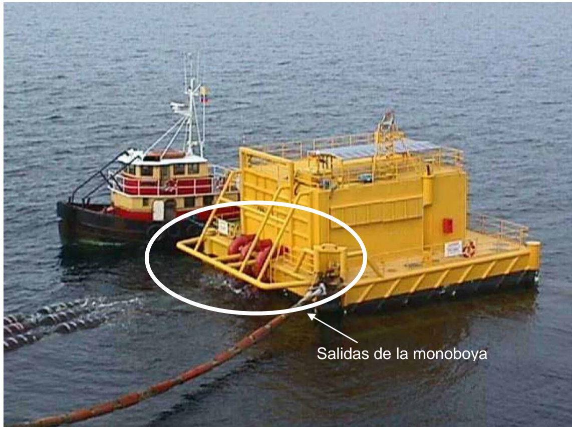
Figura 10. Salida de la monoboya hacia los Buque tanques.
