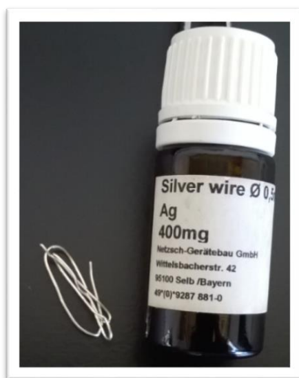
Figura 18. Hilo de plata de alta pureza (99.99%) utilizado para el grabado electroquímico
