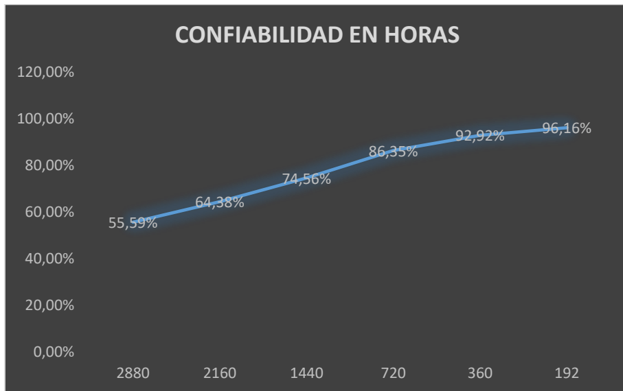
Figura 13. Gráfica de confiabilidad del motor dc de la bobinadora de salida en horas
