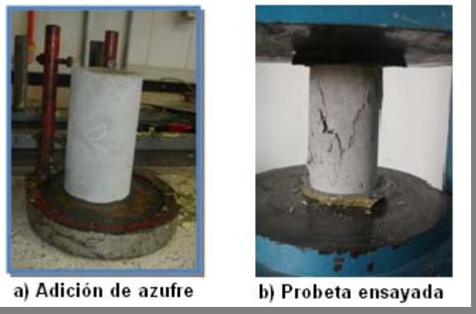
Fotografía 10. Ensayo de Resistencia a la Compresión.
