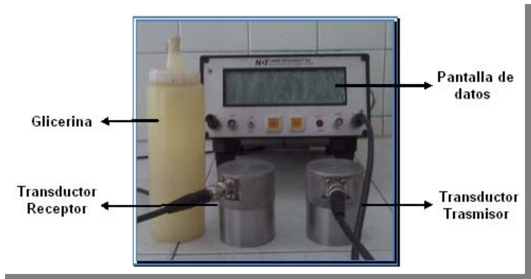
Fotografía 1. Equipo de Ultrasonido, V Meter MK II
