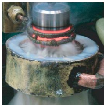
Figura 13. Proceso de Temple por Inducción
