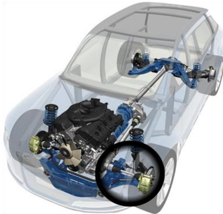
Figura 4. Ubicación del eje homocinético en un vehículo tipo.
