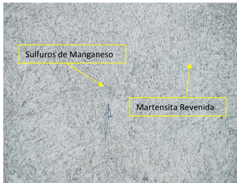
Figura 5. Microestructura del acero 4330, realizada a 1400x
