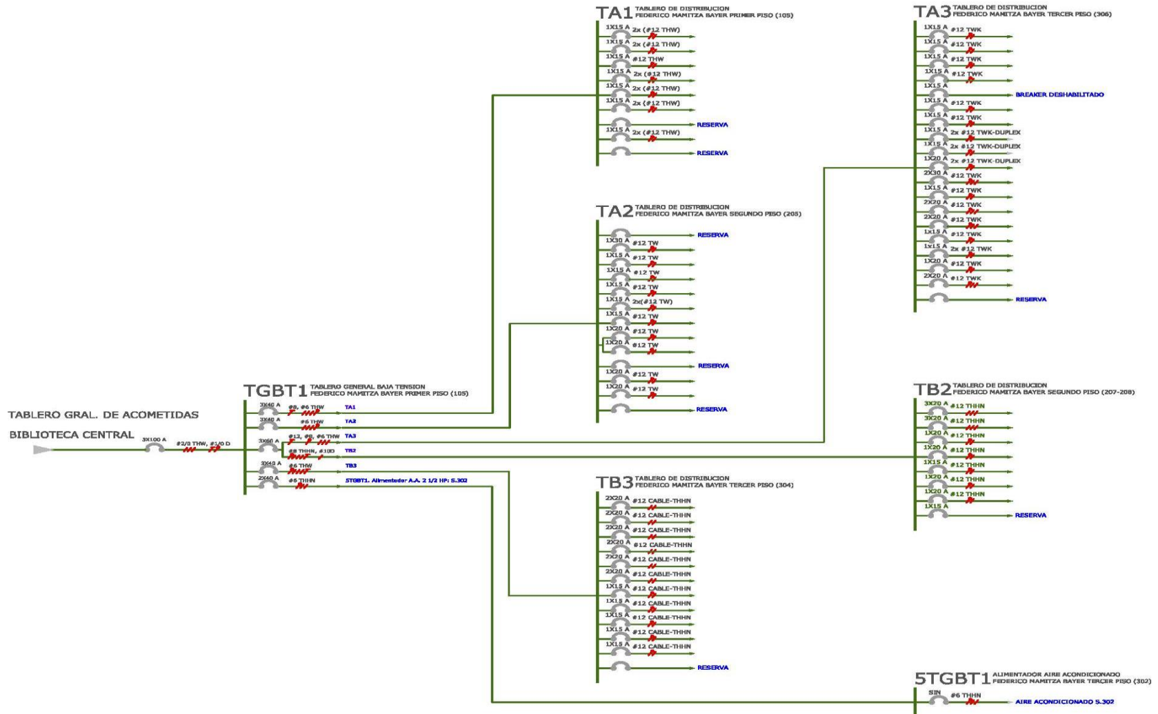
Figura 6. Diagrama Unifilar Ed. Mamitza Bayer TG 1
