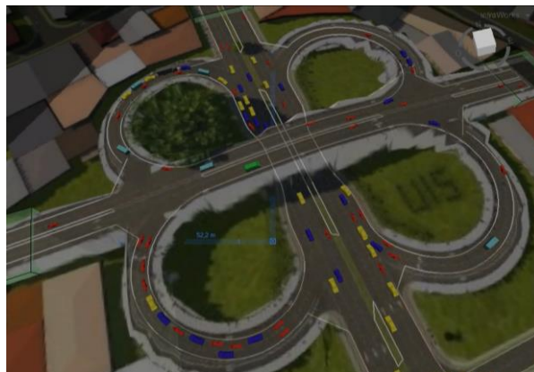
Figura 16. Resultado de simulación de tránsito de propuesta enlace tipo trébol.
