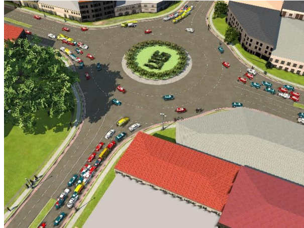
Figura 14. Resultado de simulación de tránsito de propuesta glorieta.
