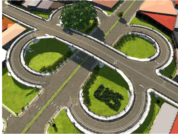
Figura 15. Propuesta de enlace tipo trébol desde Infraworks
