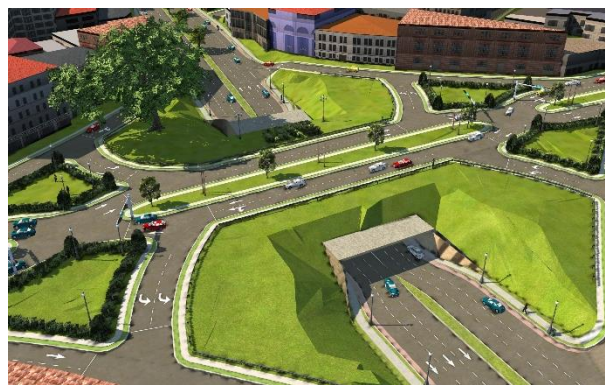
Figura 18. Resultado de simulación de tránsito de propuesta intercambiador diamante divergente.
