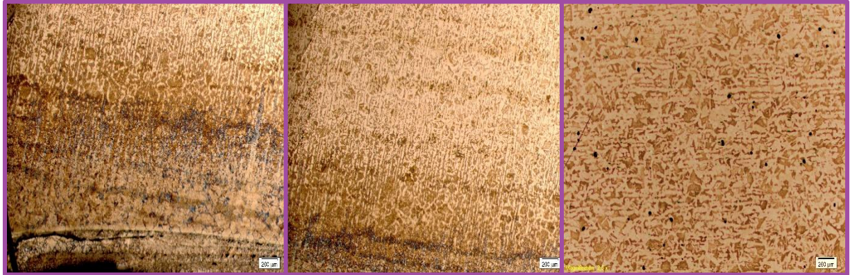
Figura 31. Cambio microestructural del borde hacia el centro de la cuba a 50X, atacada con nital
