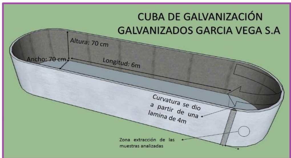
Figura 30. Cuba GALVANIZADOS GARCIA S.A
