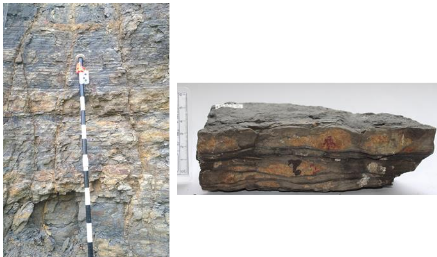
FIGURA 12: Intercalaciones de niveles de biolaminitas con láminas competentes arenosas
