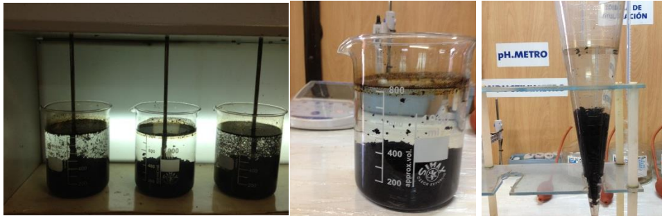
Figura 41. Agua de retrolavados después de la adición de coagulante y floculante
