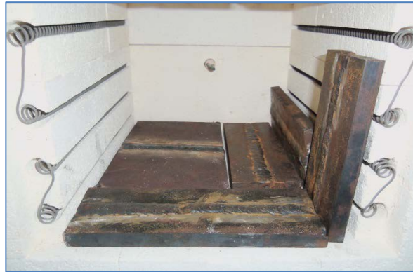
Figura N°11. Placa soldada en T.T. de Step Cooling
