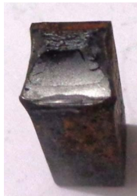
(C) SC –con hidrógeno a 96 horas
