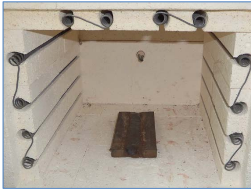
Figura N°9. Placa soldada en T.T. de PWHT
