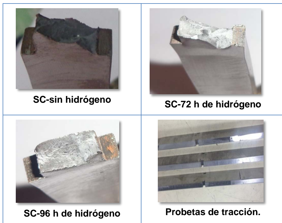
Figura N° 30. Análisis de fractura en probetas envejecidas – hidrogenadas y no hidrogenadas
