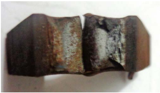
Figura N° 29. Análisis de fractura en probetas envejecidas – hidrogenadas ZAT
