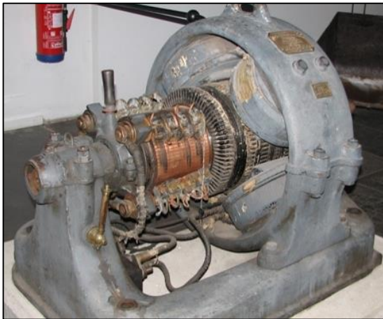
Figura 4. Motor eléctrico oxidado,
