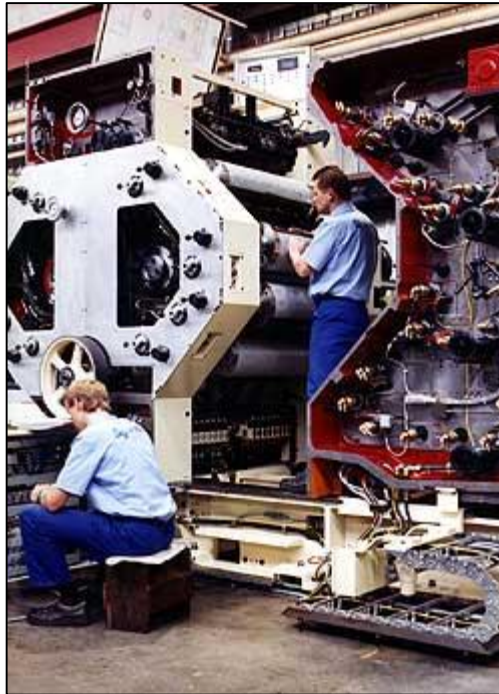
Figura 5. Lugares de difícil acceso para limpieza en impresoras de billetes.
