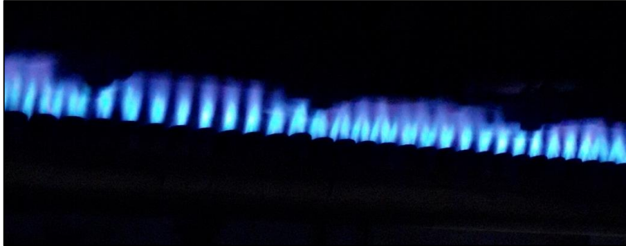
Figura 48. Oscilación de llama.
