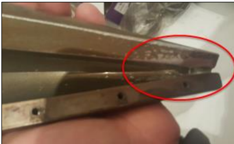
Figura 52. Desgaste de teflón.
