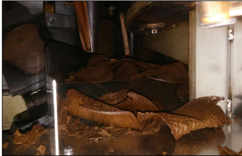
Figura 53. Acumulación de desperdicio en lugar de difícil acceso.
