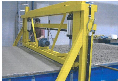
Figura 11: Estación de acabado superficial primario
