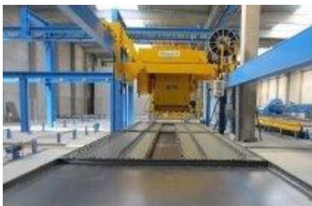
Figura 10: Estación de colocación, distribución y vibrado del concreto
