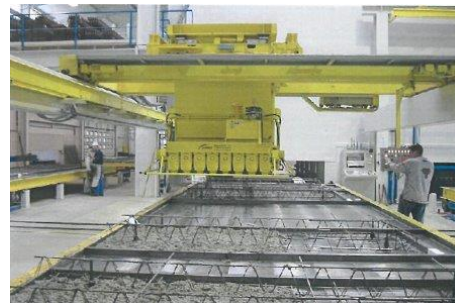
Figura 10: Estación de colocación, distribución y vibrado del concreto
