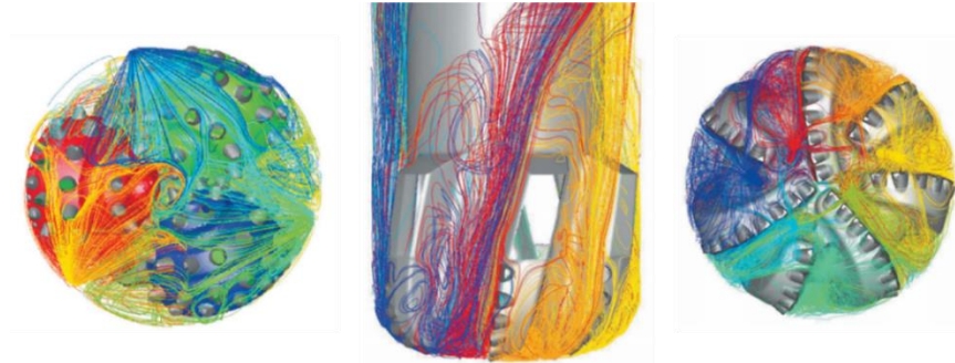
Figura 11. Análisis del flujo de un fluido de perforación en una broca tricónica y PDC. Adaptado de Fundamentals of Drilling Engineering. Society of Petroleum Engineers. Mitchell, R. F., & Miska, S. (2011).
