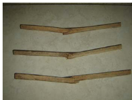
Figura 37. Falla típica en las probetas a impacto
