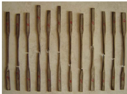
Figura 33. Posición típica de las fallas a tracción paralela
