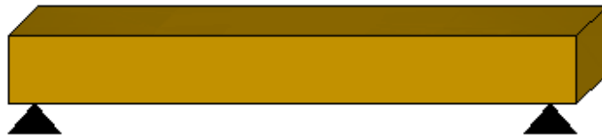
Figura 20. Viga simplemente apoyada
