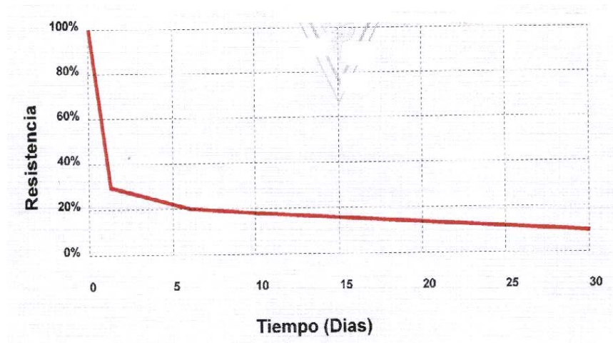
Figura 25. Reducción de la Resistencia de Puesta a tierra con Favigel.
