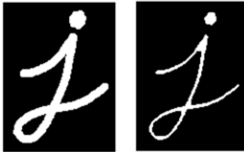
Figura 17. Erosión de una imagen.
