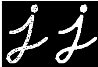
Figura 20. Operación cerradura. Imagen original e imagen resultado.
