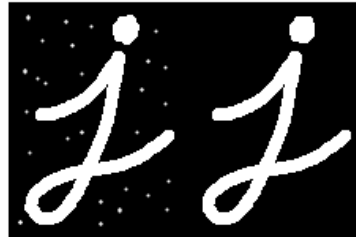
Figura 19. Operación de apertura. Imagen original e imagen resultado.
