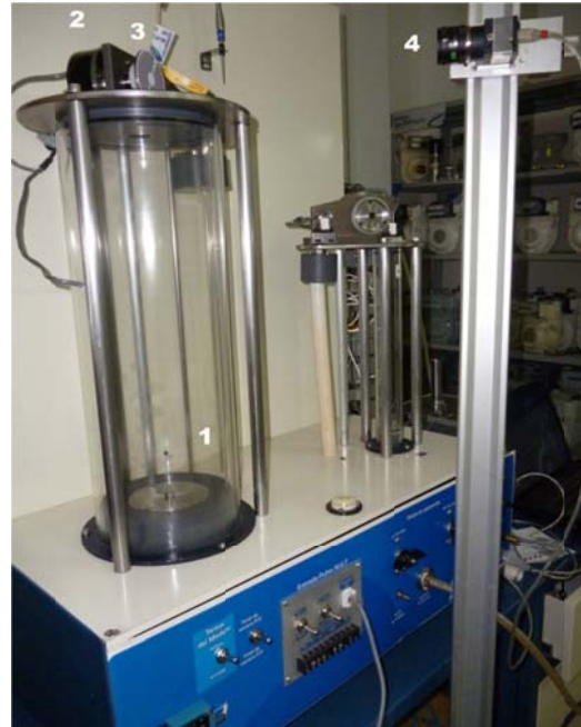
Figura 29. Montaje: 1. Pistón, 2. Encoder, 3. Rejilla Radial, 4. CCD
