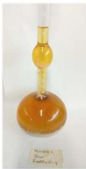
Figura 9. Matraz de Lechatelier con Diesel para la Muestra N°2(Cesar), repetición 4.
