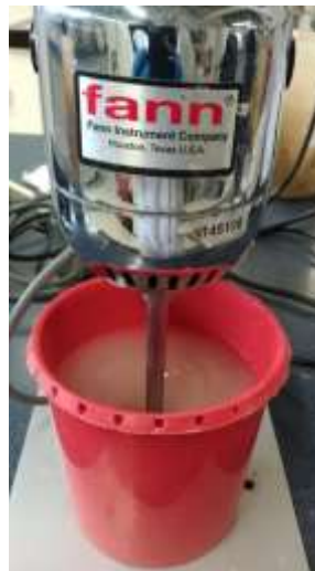
Figura 14. Aspecto físico del lodo base usado para el rendimiento de las muestras.
