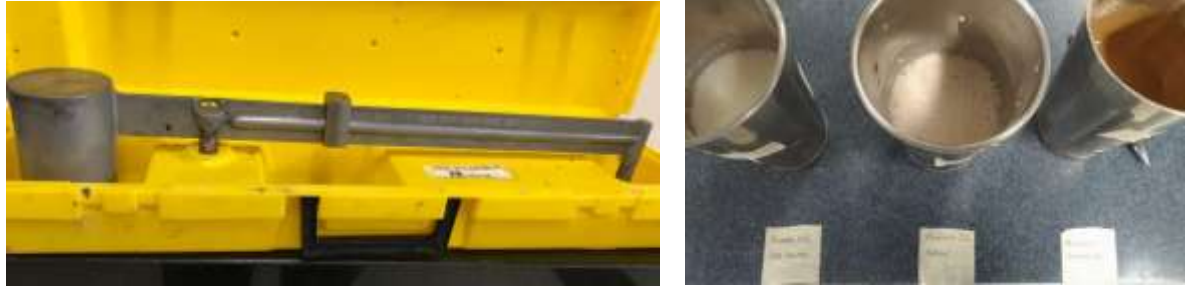
Figura 15. Tonalidad de los lodos obtenidos y balanza de lodo usada.
