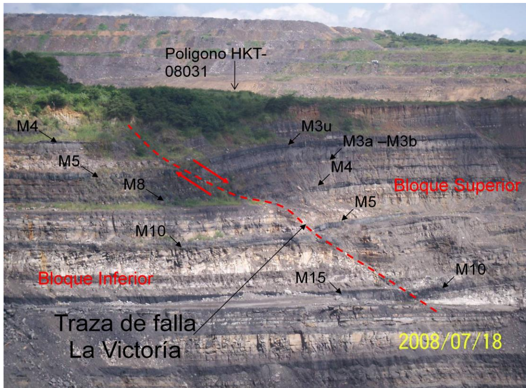
Figura 2.7. Falla La Victoria. Fotografía tomada en el tajo Tesoro, sector central del sinclinal La Jagua.
