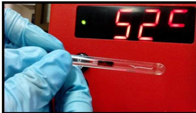
Figura 15. Tubo Capilar de Diámetro Interno de 2mm
