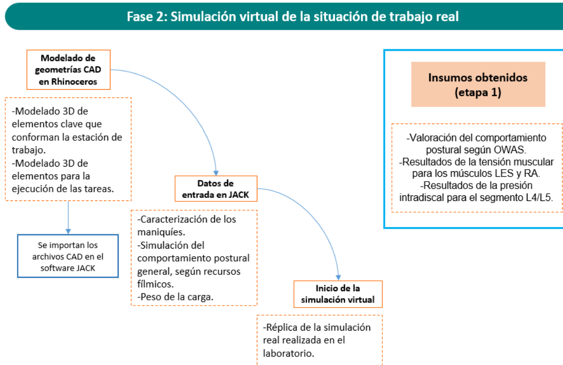
Figura 20. Etapas de la fase de simulación virtual de la situación de trabajo real en el software JACK.
