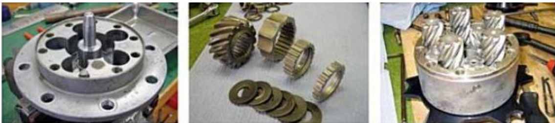
Figura 63. Internos de un diferencial tipo TORSEN
