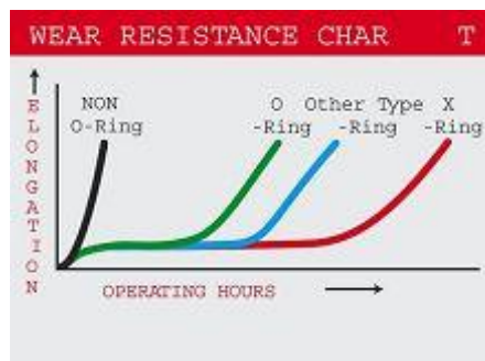
Figura 55. Comparación al desgaste de diferentes tipos de cadenas
