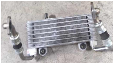
Figura 46. Radiador para refrigerar aceite
