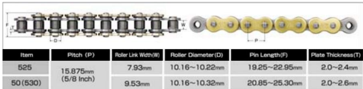
Figura 80. Especificaciones geométricas cadena FORSSA (DID 530)
