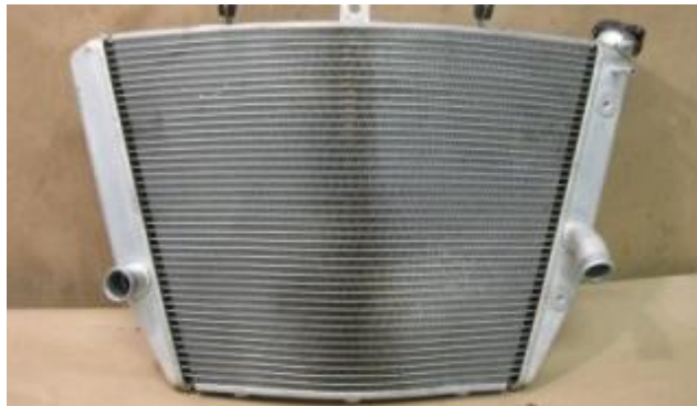
Figura 44. Radiador para refrigerar el agua
