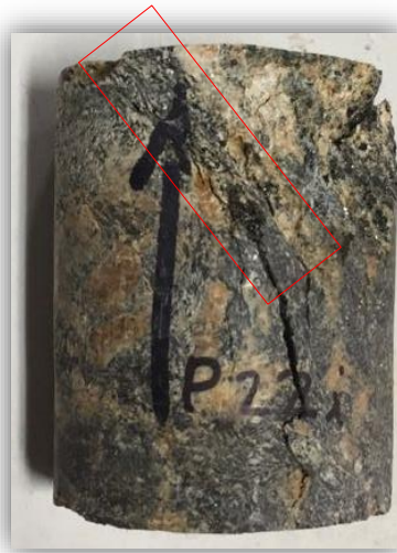
Figura 33. Fractura del núcleo P22i / 7.20-9.90 por debilidad asociada a foliación.
