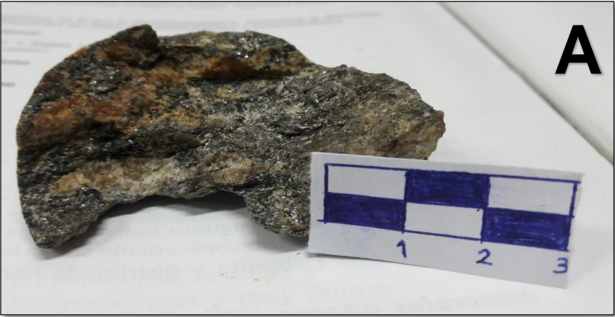
Figura 15. A- Estructura esquistosa B- Textura lepidoblástica de la unidad Esquistos del Silgará.
