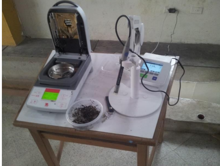
Fotografía 1. Instrumentos citados para la toma y registro de datos de pH y humedad.
