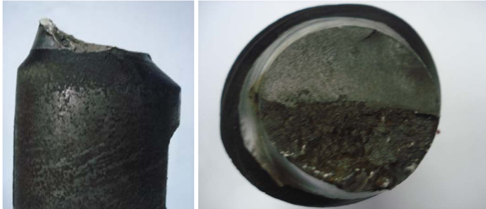
Figura 4-14: Muestra de rotor con evidencia de corrosión.
