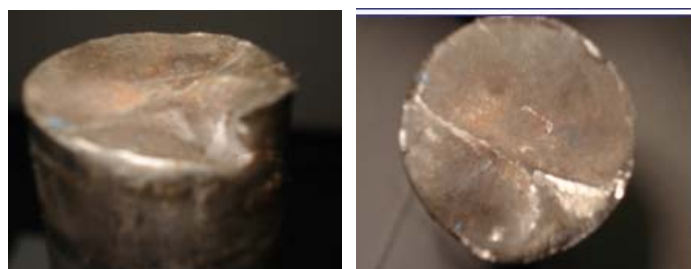
Figura 4-34: Presencia de Corrosión en Corod vista frontal.
