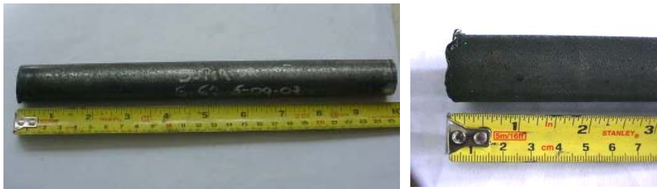
Figura 4-16: Muestra 2 de varilla de acero al carbono, GUA-069
