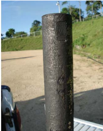
Figura 4-46: Presencia de corrosión en Shear Coupling.
