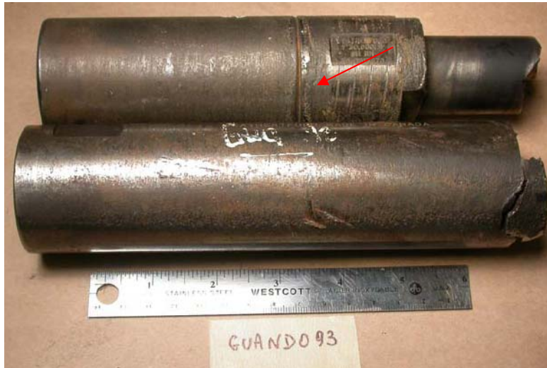
Figura 4-53. Sección de shear coupling con fractura.
