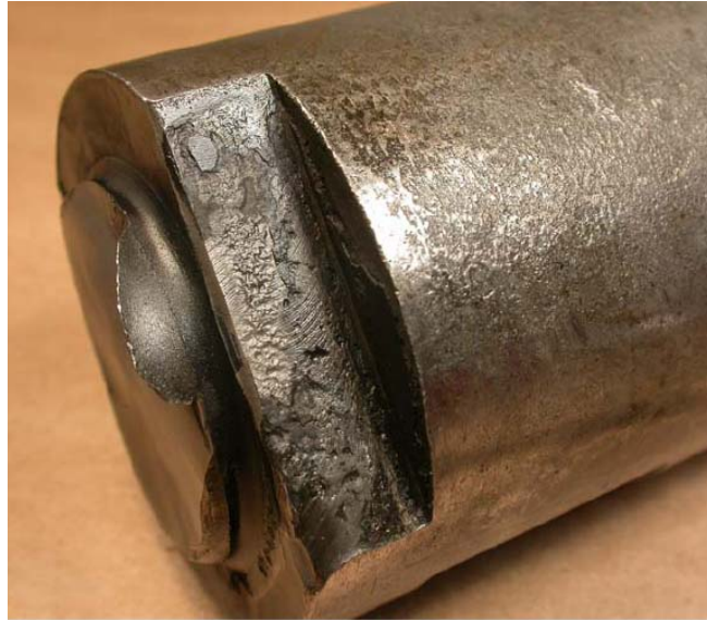
Figura 4-11: Area del Clutch de shear coupling con corrosión
