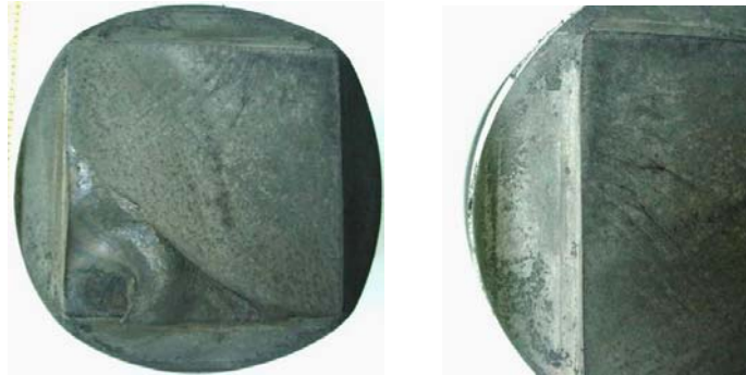
Figura 4-26: (a) Morfología de la superficie de fractura. Zona de inicio de la falla I y zona de rotura final T .
