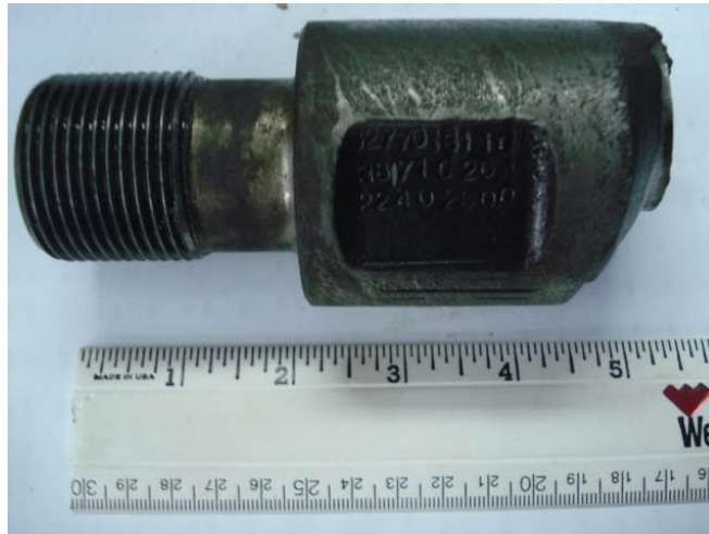
Figura 4-13: Cabezal de Rotor Bomba PCP GUA-069
