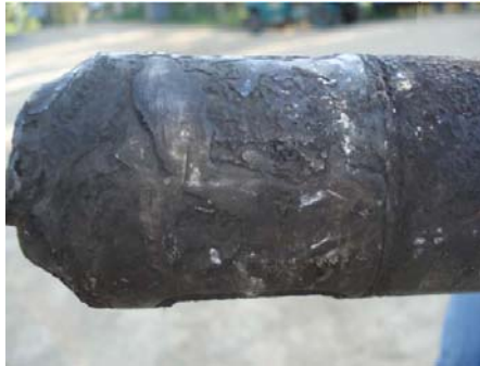
Figura 4-49: Cabera de Rotor con presencia de corrosión.
