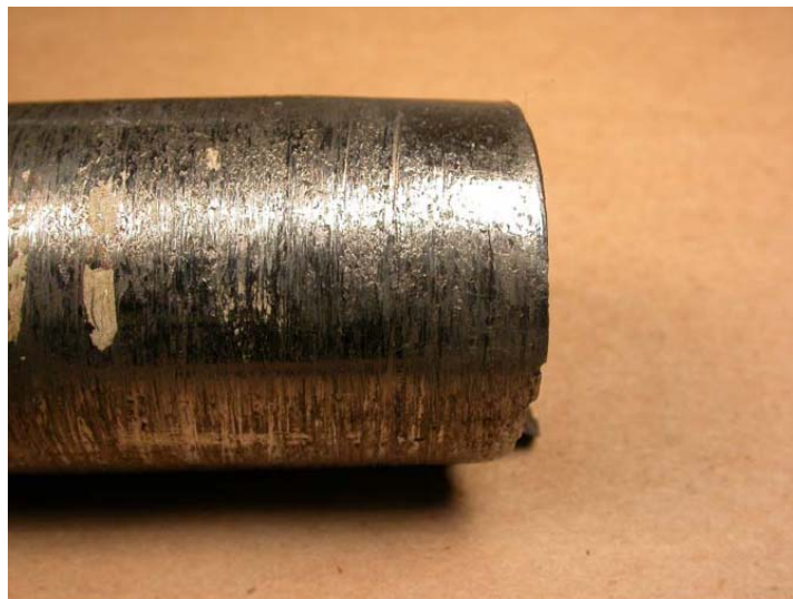
Figura 4-60. Desgaste por abrasión en varilla.
