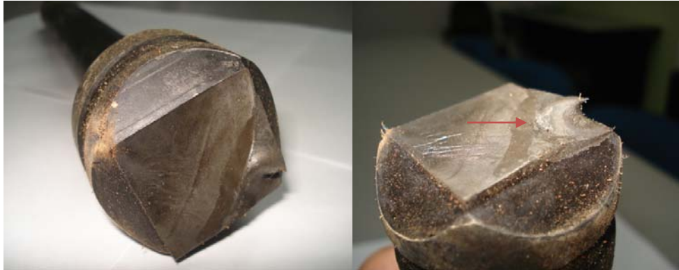
Figura 4-5: Rotura por fatiga asistida por corrosión.
