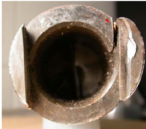
Figura 4-54. Área de mandíbulas que muestran deformación mecánica y fractura.
