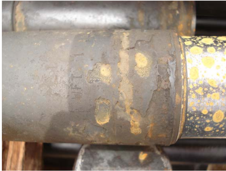
Figura 4-57. Corrosión por CO 2 en box.
