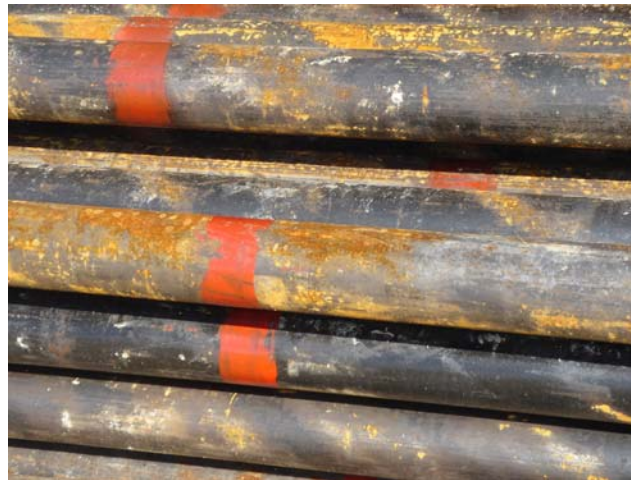
Figura4-6: Corrosión en varilla continua (Corod)
