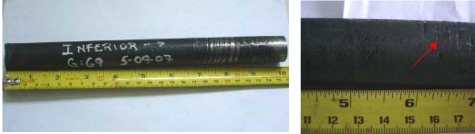
Figura 4-15: Muestra 1 de varilla de acero al carbono, GUA-069
