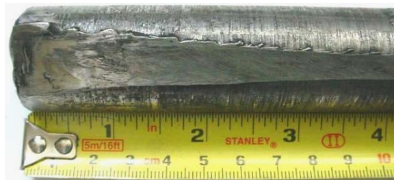
Figura 4-36: Zona de desgaste por rozamiento.
