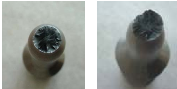
Figura 4-24. Superficie de fractura tipo dúctil. "roseta"
