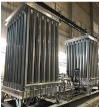
Figura 16. Vaporizadores de Aire Ambiente (AAV)
