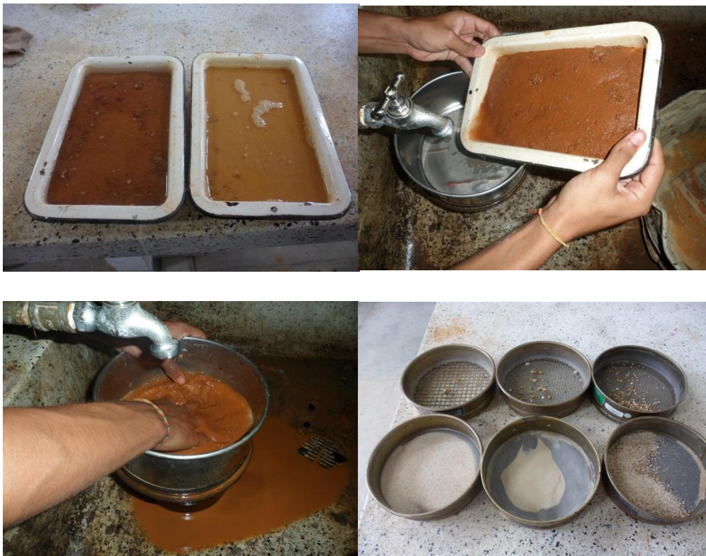
Figura 69. Procedimiento del ensayo de granulometría
